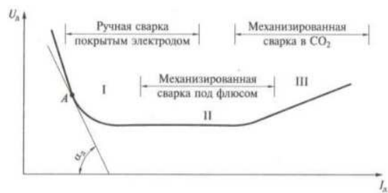
Рис. 2.3. Статическая вольт-амперная характеристика дуги: U_d , I_d — напряжение и сила тока дуги; \alpha_d — угол наклона характеристики к оси силы тока в точке A ; I, II, III — области, соответствующие падающей, жесткой и возрастающей характеристикам; I_d = \text{const}
